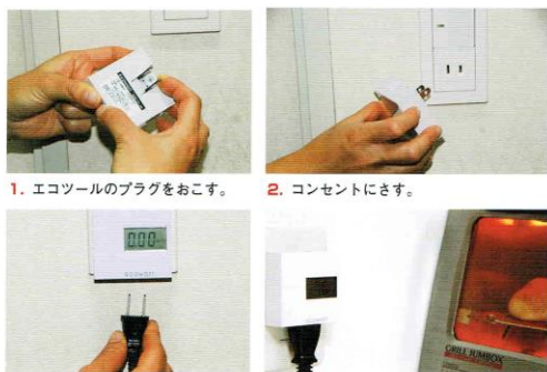
1. エコツールのプラグをおこす。 2. コンセントにさす。 3. エコツールに電気器具のコードをつなぐ。 4. 電気器具のスイッチを入れる。
